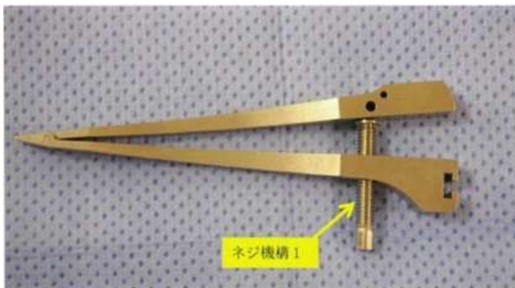
写真3② 揺動部材1のネジ機構（開いた状態）（裏側から撮影）
